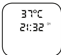
Vorheizen „AN / ON“
